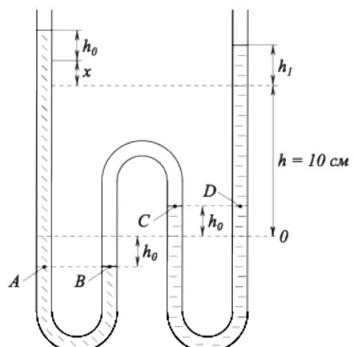
Давления в точках  $A$ ,  $B$ ,  $C$  и  $D$  по-прежнему будут одинаковы (см. предыдущий пункт). Приравняв гидростатические давления в точках  $A$  и  $D$ , получаем:
