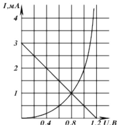
б) Обозначим токи и напряжения в этой цепи так, как показано на рисунке. Через второй диод, очевидно, будет протекать такой же ток  $I = 3 \text{ mA}$ , как и через источник. По графику вольтамперной характеристики диода находим тогда, что напряжение на нем  $U \approx 1,1 \text{ В}$ . Значит, напряжение на первом диоде (и резисторе)
