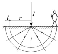
Как видим, это напряжение уменьшается при удалении от места удара. Минимальное безопасное расстояние – то, на котором  $U$  становится порядка 50 В. Выражая из формулы  $r$ , получаем:
