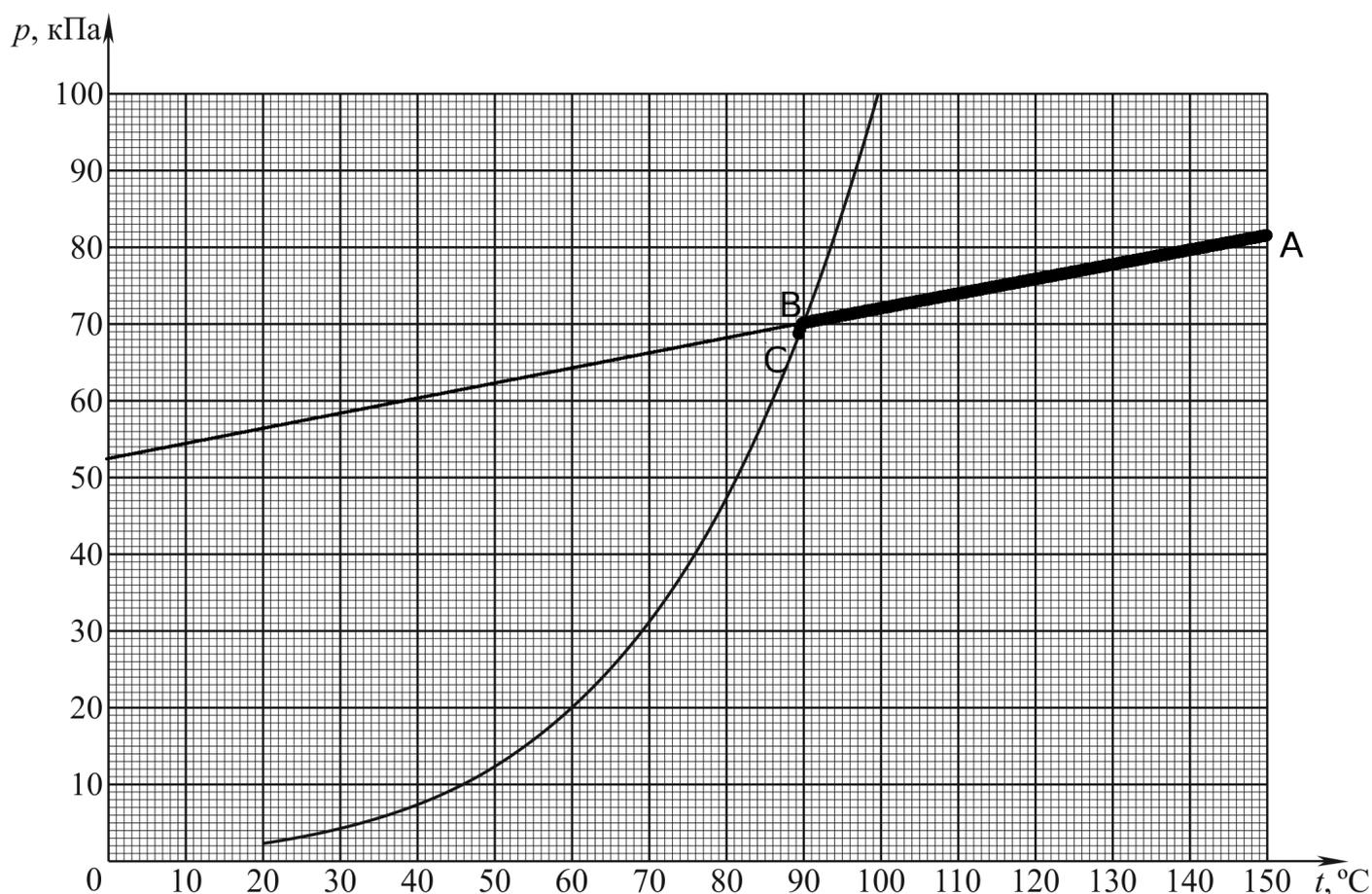
Соединив эти точки прямой, мы видим, что конденсация пара начнется при температуре  $90^\circ\text{C}$  и давлении  $p = 70 \text{ кПа}$ . Разумеется, участок этой прямой левее точки  $B$  не имеет физического смысла. Он нужен нам только для того, чтобы наиболее точно найти пересечение прямой и кривой на графике. Конечную точку всего процесса назовем точкой  $C$ .
