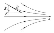
Циклотронный радиус (радиус окружности, по которой движется ион в магнитном поле) мал по сравнению с расстоянием, на котором магнитное поле существенно изменяется. Плазму считайте разреженной, так что столкновениями ионов друг с другом можно пренебречь.
