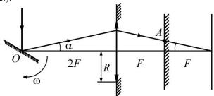
Значит, расстояние от точки A до главной оптической оси линзы равно x=Ftg  $\alpha \approx F\alpha$  (поскольку формула тонкой линзы справедлива в параксиальном приближении, то угол  $\alpha$  должен быть малым). Значит, модуль скорости светового пятна равен
